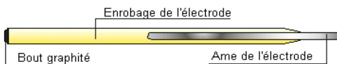
**1) L'âme** : partie métallique cylindrique placée au centre de l'électrode.
